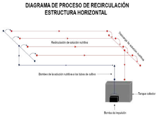
Figura 2. Diagrama del proceso de recirculación en la estructura horizontal
