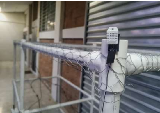
Figura 6. Ubicación de sensor DHT22 en la estructura
